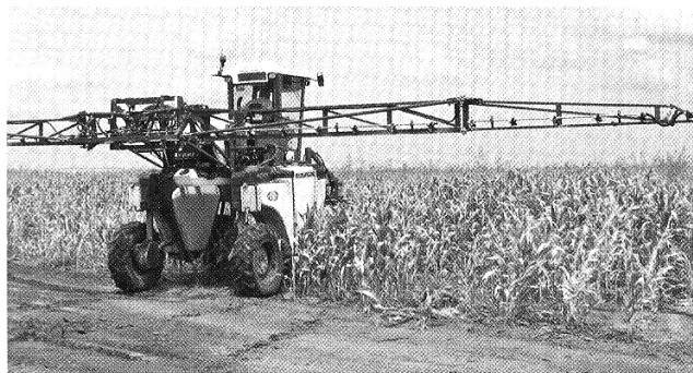
Sl. 2 Čupač metlica s adaptiranom prskalicom
