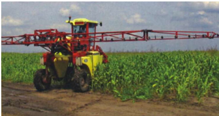
Sl. 2. Čupač metlica sa adaptiranom prskalicom
