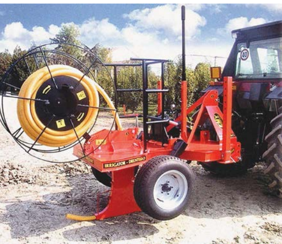
Слика 4. Машина за постављање дренажних цеви
