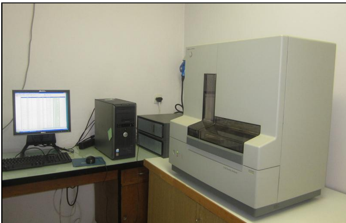
Слика 4. Капиларна електрофореза на аутоматском секвенцеру Applied Biosystems - ABI Prism 3130
