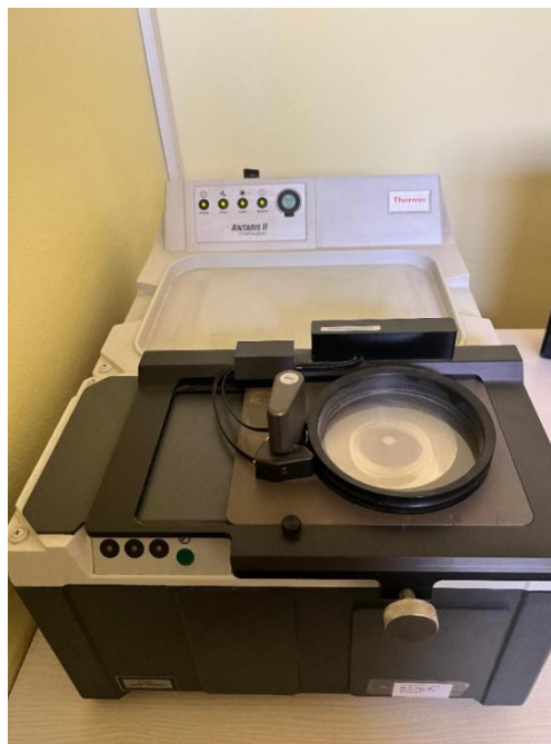
Слика 5: Уређај за мерење протеина спектроскопијом у блиској инфрацрвеној области (FT-NIRS), типа Antaris™ II FT-NIR Analyzer (ориг. тр А. Ухларик)
