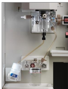
Slika 3. ABI Genetic Analyzer 3130 (gore), detalj pumpe za ubacivanje polimera u sistem kapilara (dole levo) i sistem kapilara (dole desno) ( https://www.lifetechnologies.com/ )
