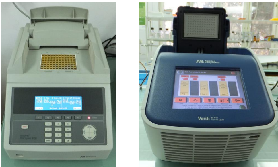
Slika 2. PCR aparati, PCR System 9700 gold (levo) i Veriti Thermal Cycler (desno)
