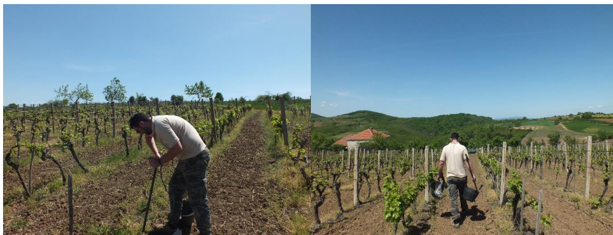
Fot. 1. (levo) i 2. (desno). Uzorkovanje pomoću agrohemijske sonde na dve dubine zemljišta 0–30 i 30–60 cm
