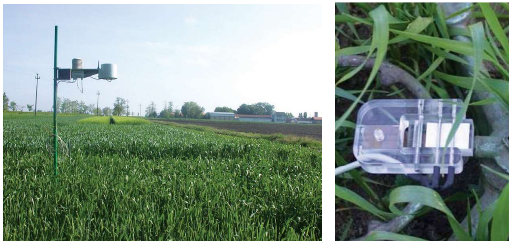
Sl. 1. Automatska mini meteorološka stanica iMETOS®sm i senzor za dužinu merenja vlaženja lista u lokalitetu Rimski Šančevi
