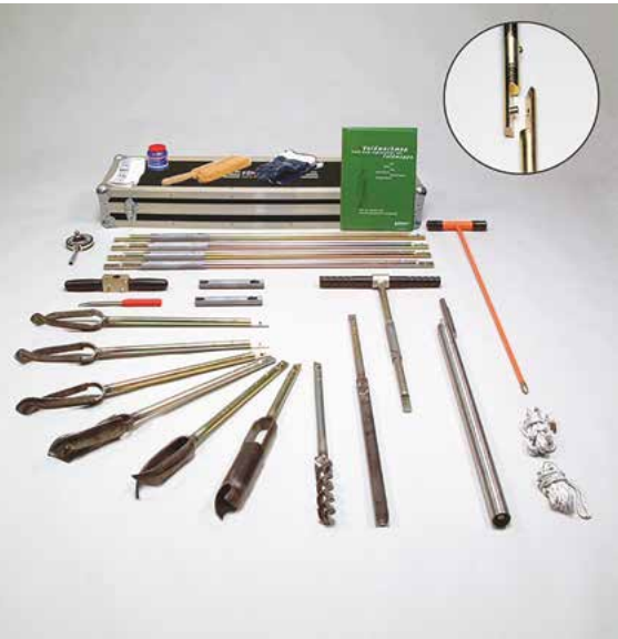
Слика 25: Део опреме (сонде) коришћене за узимање узорака
