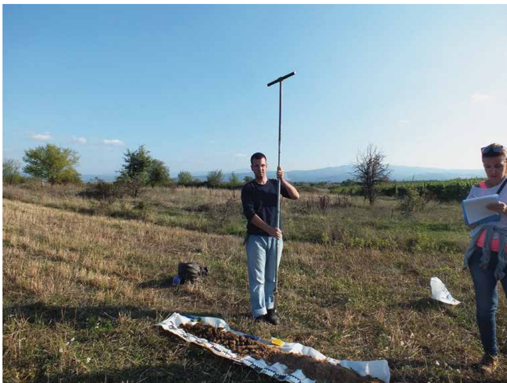
Слика 21: Узимање узорака сондом из контролних бушотина
