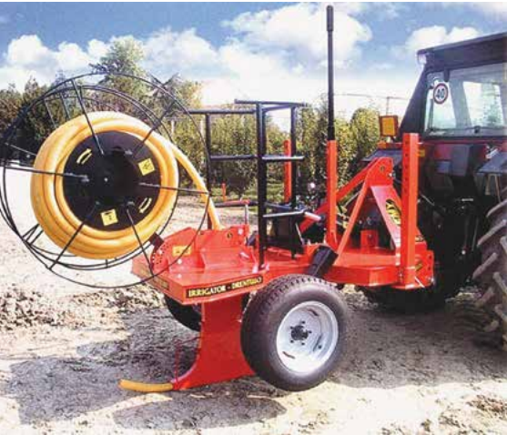
Слика 5. Машина за постављање дренажних цеви
