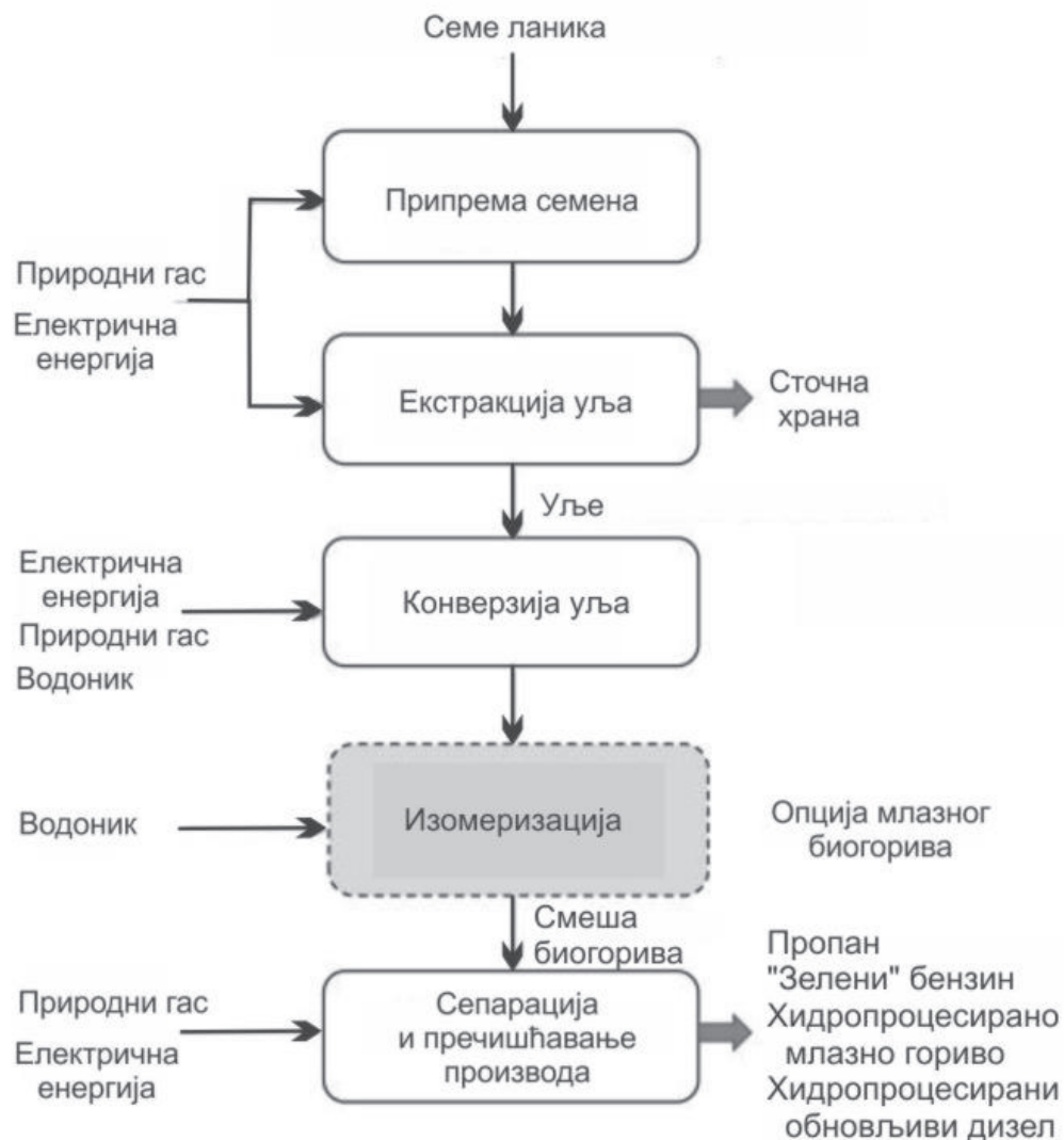
Слика 8.4 Технолошка шема каталитичког хидропроцесирања уља ланика (адаптирано према Chu и сар. 2017b)
