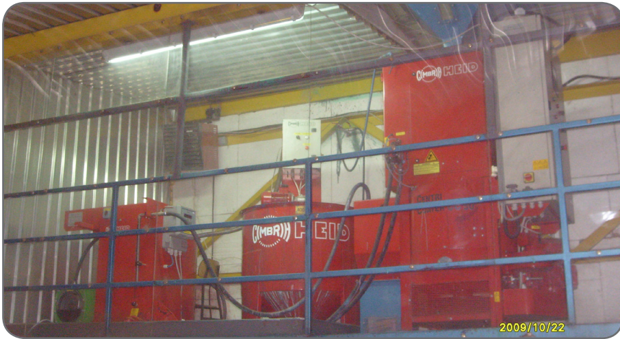
Slika 27. Centrifugalni zaprašivač CC 50 Figure 27. Centrifugal duster (Radić i Čanak, 2009)
