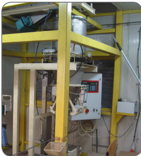
Slike 29 i 30. Linija za pakovanje semena i digitalna vaga na liniji za pakovanje Figures 29 and 30. Sunflower seed packing line and digital scale (Čanak, 2009)
