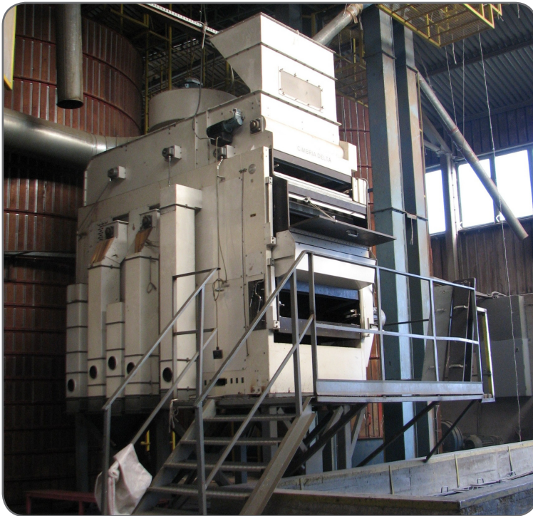
Slika 6. Grubi čistač (pretčistač) tipa DELTA (CIMBRIA HEID) u Institutu za ratarstvo i povrtarstvo iz Novog Sada
