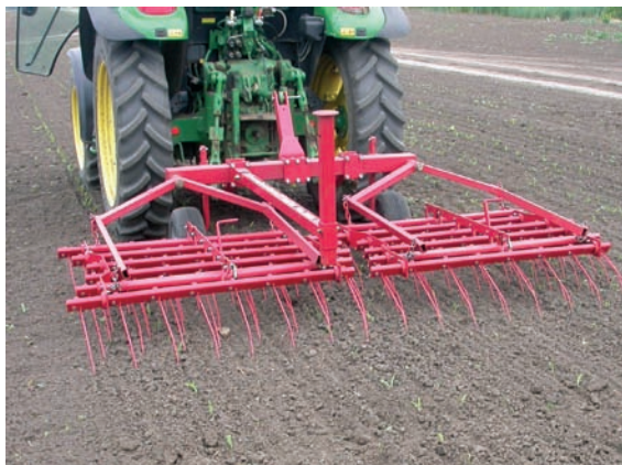
Brana sa opružnim zupcima u radu / Foto: Dr Goran Malidža
