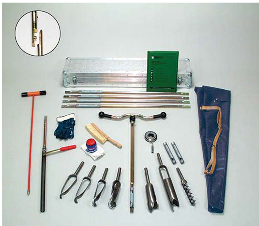
Слика 20: Део опреме (сонде) коришћене за узимање узорака
